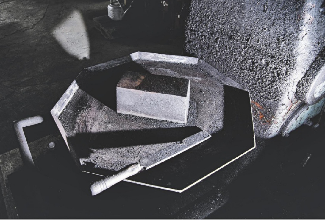
In Kanekuni Ogawas Schmiede: Das längliche Werkzeug, ein Kanahada-Tori, dient zum Entfernen der oxidierten Schicht nach dem Formen der Klinge
